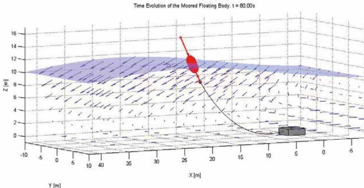
Resinex ha messo a punto in collaborazione con il Mox del Politecnico di Milano un programma di simulazione che prende in considerazione le principali variabili meteo-marine da abbinare alle centinaia di modelli di boe per valutarne il comportamento in situazioni estreme.
